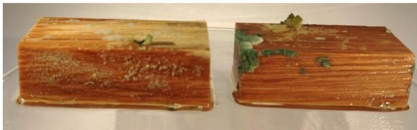
Abbildung 10: Prüfklotz Eiche, linke Seite; links: Mondholz, rechts: Referenzholz
