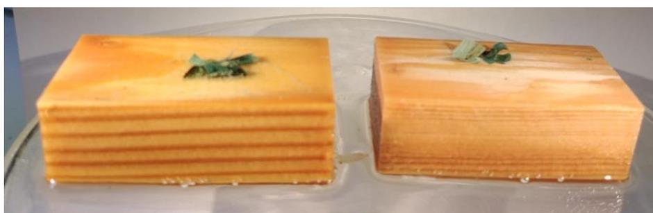
Abbildung 22: Prüfklotz Lärche linke Seite; links: Mondholz, rechts: Referenzholz
