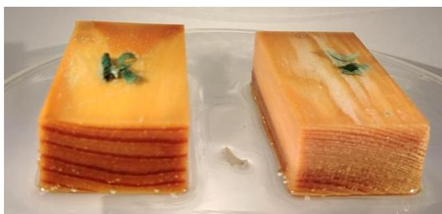
Abbildung 23: Prüfklotz Lärche hinten; links: Mondholz, rechts: Referenzholz
