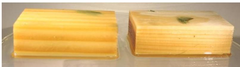
Abbildung 18: Prüfklotz Fichte linke Seite; links: Mondholz, rechts: Referenzholz
