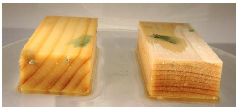
Abbildung 19: Prüfklotz Fichte hinten; links: Mondholz, rechts: Referenzholz
