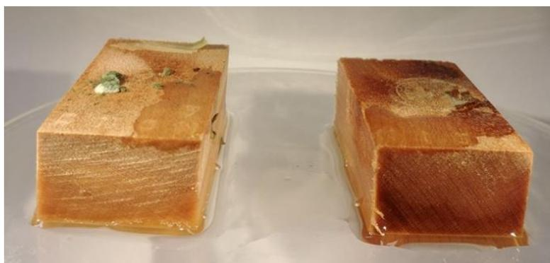
Abbildung 15: Prüfklotz Ahorn, hinten; links: Mondholz, rechts: Referenzholz
