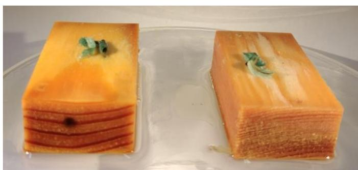
Abbildung 21: Prüfklotz Lärche vorne; links: Mondholz, rechts: Referenzholz
