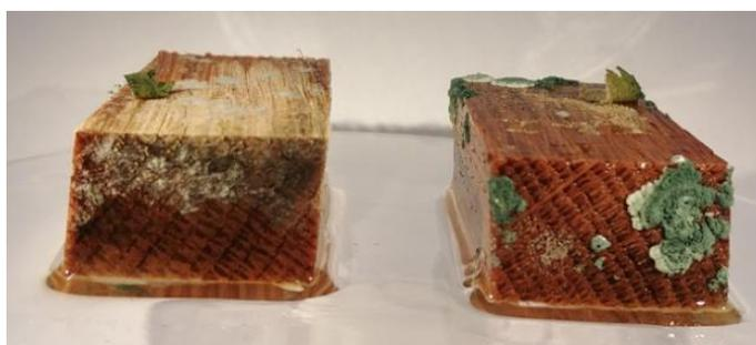
Abbildung 11: Prüfklotz Eiche, hinten; links: Mondholz, rechts: Referenzholz
