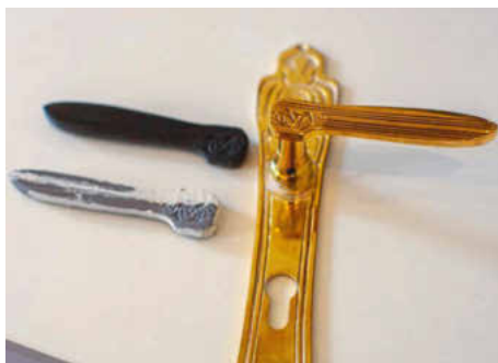
/ Links Vorlagen für den Griff und rechts der fertig gedruckte Griff in Messing.
