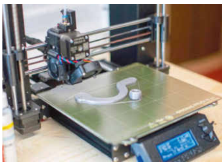
/ Im 3-D-Drucker wird das Plättchen für eine Schiebetürgriffschale gedruckt.
