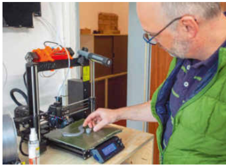
/ Update beim Filament-3-D-Drucker: Somit konnte der orange Gehäusedeckel selbst gedruckt werden.
