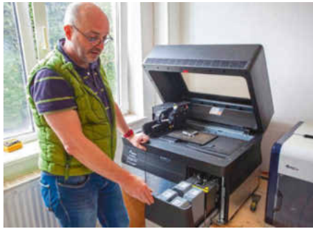
/ Das beste Pferd im Stall: Der große 3-D-Drucker hat die Materialzuführung direkt integriert.
