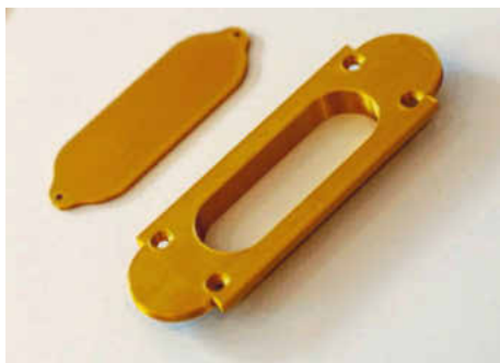
/ Der Tischler erhält ein gedrucktes Kunststoffmuster, mit dem er die passenden Fräsungen einbringen kann.
